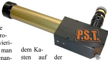
dem Kasten auf der nächsten Seite ersichtlich: Bei einer Öffnung von 40mm und einem Öffnungsverhältnis von  $f/10$  handelt es sich um einen kleinen Refraktor. Gute Erfahrungen haben wir bisher mit Okularen gemacht, die bei einer Brennweite um die 10mm eine Vergrößerung von 40fach erzielen. Damit sind die Protuberanzen am Sonnenrand, die Fackeln auf der Sonnenscheibe und die Granulation auf der Oberfläche der Sonne sehr gut zu erkennen. Innerhalb einer Zeitspanne von 15-30
